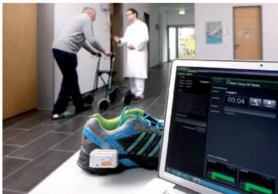
Sensor-basiertes mobiles Ganglabor
